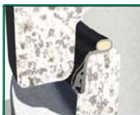
1. ניקוי שטחי המגע. הרכבת האטם במקומו על הזכר. (אין צורך במשחת החלקה).
